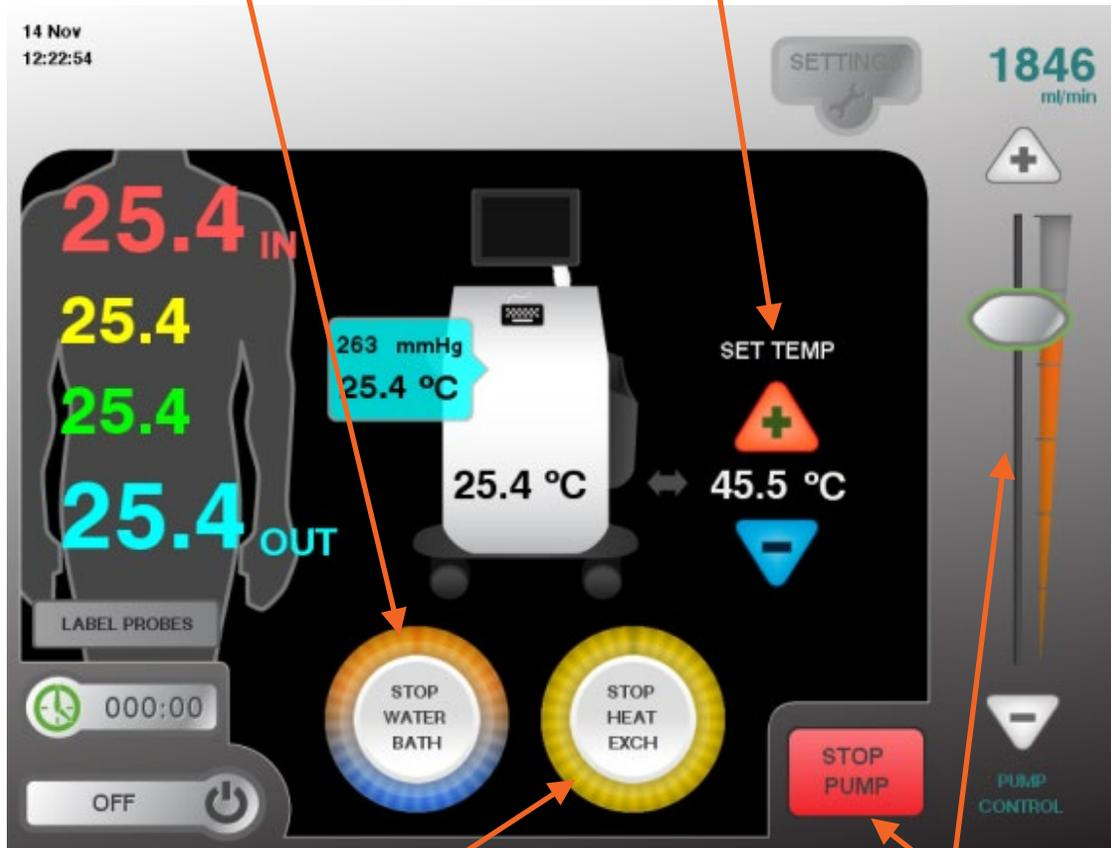
**3** Taste 'START HEAT EXCH' drücken um die Wärmetauscher Wasserzirkulation zu starten.
