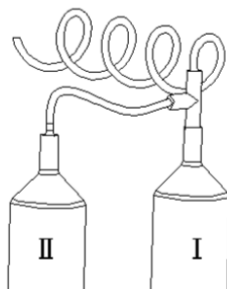
Conexión del tubo conector T con las jeringas
