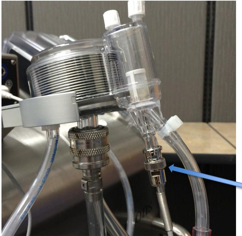
2. Conecte el sensor de presión desechable a la primera conexión Luer Lock detrás de la bomba de rodillos.
